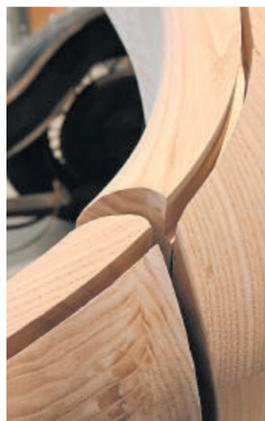
Millimetergenaue Frästeile mit Ausdehnungen in mehreren Richtungen wurden im Fahrzeug-Aufbau montiert. 131 an der Zahl.
